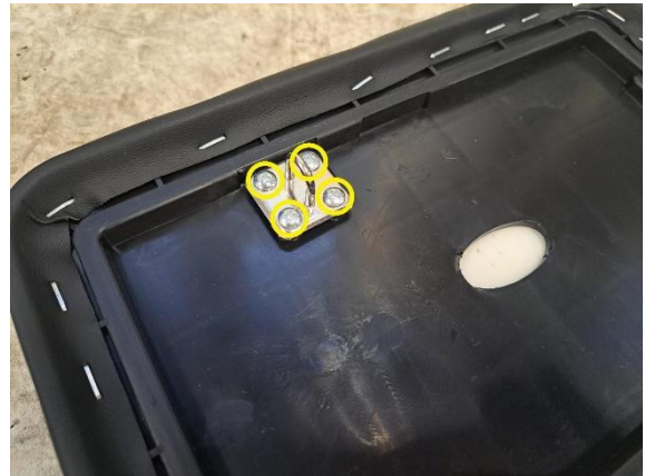
Irrota takaistuimen lukon kiinnitysruuvit (ristipäämeisseli ph2).
