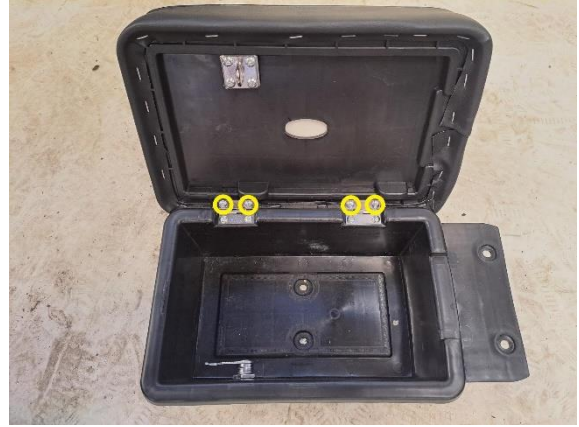
Irrota takaistuimen kiinnitysruuvit (ristipäämeisseli ph2).
