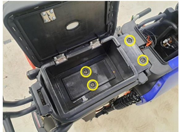
Avaa takapenkki ja irrota takapenkin kiinnityspultit (kuusiokoloavain 5 mm).
